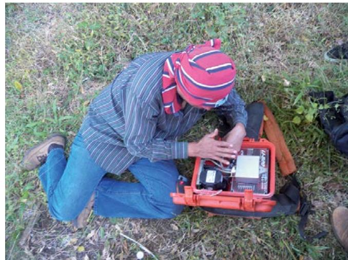
Preparación de cámara de medición CO<sub>2</sub> en perímetros volcán de San Miguel.
