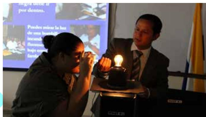
Viendo la dispersión de la luz a través de un espectroscopio casero.
